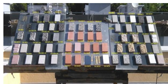
Ilustración 2. Dispositivo experimental para la exposición de las muestras en condiciones de intemperie.
